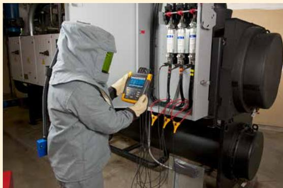
Collegate semplicemente i terminali di misura della tensione e le sonde di corrente flessibili all'alimentazione del motore.
